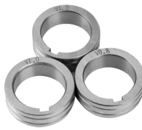
RODILLOS GUIA CANAL EN V. Rodillos acerados para alambres sólidos para aceros al carbono y aceros inoxidable. 0.8mm – 1.0mm: BSO3013547 1.0mm – 1.2mm: BSO3013548 1.2mm – 1.6mm: BSO3013555
